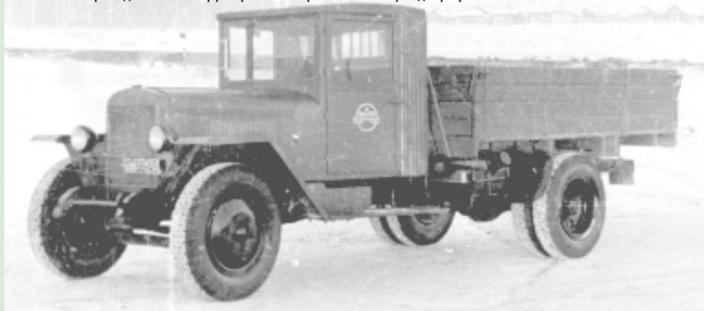
Испытания изменения топливной системы, дверок кабины на ЗИС-5В. Автомобиль принадлежал Конструкторско-экспериментальному отделу УралЗИС. 1945–1946 гг.
