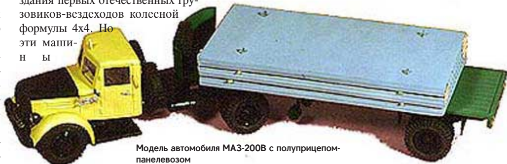
Седельный тягач МАЗ-200В с полуприцепом МАЗ-5215Б грузоподъемностью 12,5 т
